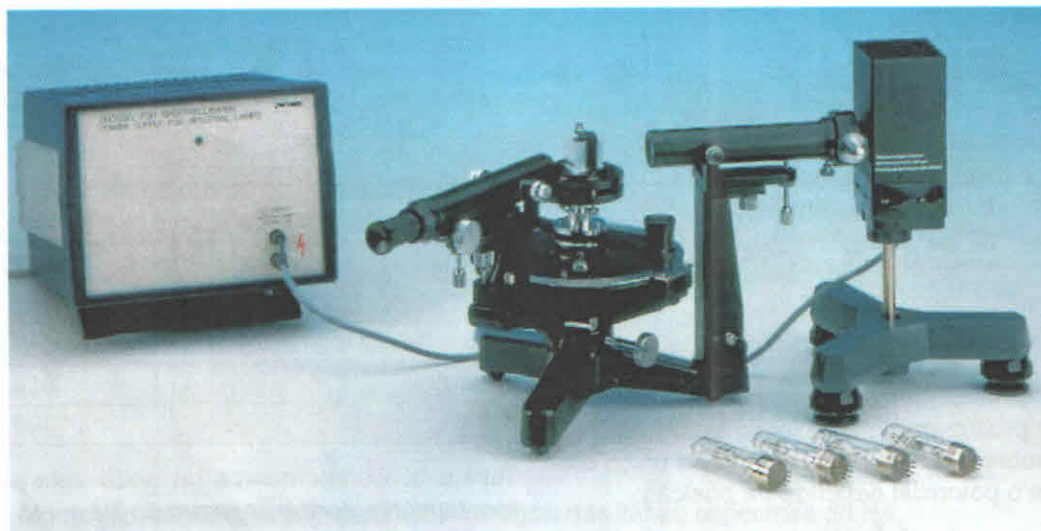
Fig. 4: Montagem experimental para a medição do espectro de Hg, Cd e Zn.
