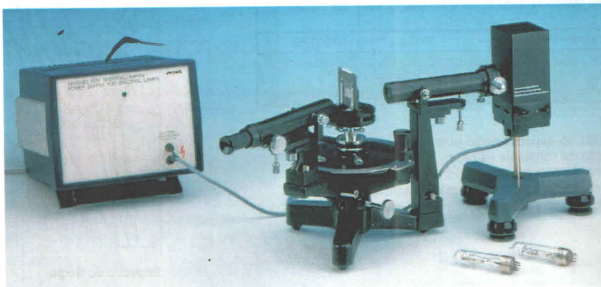
Fig. 1: Montagem experimental para a determinação das linhas espectrais do Na.
