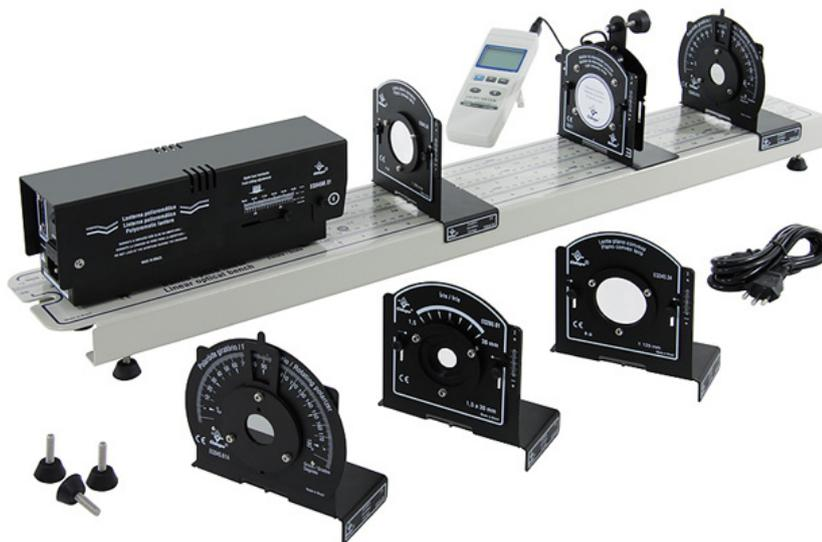
Figura 1.10: Aparato experimental para estudo da polarização da luz.
