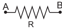
Figura 1.1: Representação esquemática de um resistor colocado entre os pontos A e B de um dado circuito.
