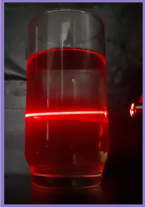
Um dos processos de síntese que realizamos no projeto foi a síntese de nanopartículas (NP) metálicas. Utilizamos dois pedaços de cobre, ligados a uma bateria, em solução aquosa. Esse processo gerou uma dissociação atômica formando as nanopartículas.
