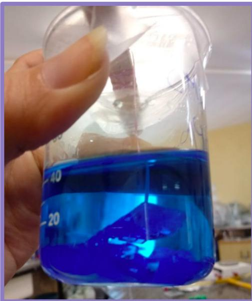
O que ocorre é que ao retornar para a temperatura de  $20^\circ\text{C}$ , voltamos a ter 6g de  $\text{Cu}(\text{SO})_4$  em excesso. Estes átomos juntam-se ao nosso pequeno cristal, que aumentou de tamanho, como podemos ver na imagem ao lado..
